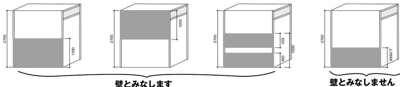
\*床から2.7mの間に、上記の図のように1m以上の造作を施工した場合、1/3以上の開口ではなく壁とみなします。(2.7m以上の部分はこの限りではありません)
